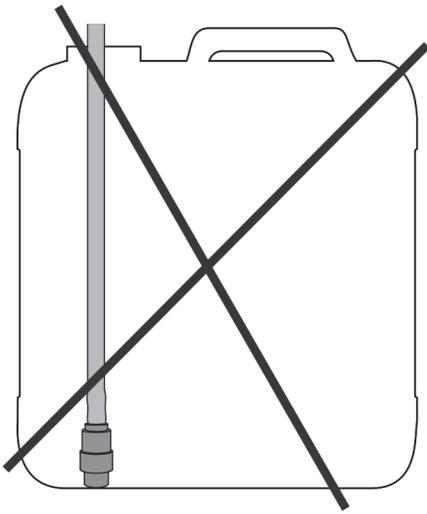
Das Bodenventil des Ansaugschlauchs darf nicht am Kanisterboden aufsetzen.
