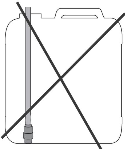
Das Bodenventil des Ansaugschlauchs darf nicht am Kanisterboden aufsetzen.
