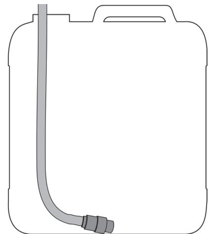
Alternativ kann eine Biegung des Ansaugschlauchs das Festsaugen des Bodenventils am Kanisterboden verhindern.
